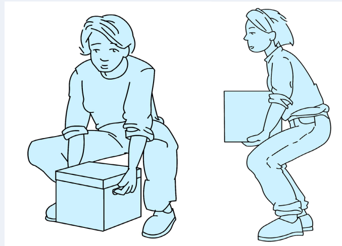
Figura 4. Levantamiento correcto de carga: espalda recta y, sin flexionar demasiado las rodillas, levantar por extensión de las piernas, manteniendo la carga pegada al cuerpo.
