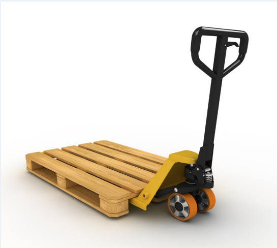
Figura 3. Palé de madera sobre el que se pretendía depositar la cuba. Material y equipo de similares características a los implicados en el accidente.
